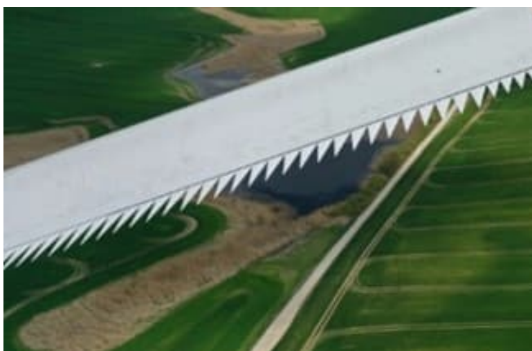
Figure 17 : Système de peigne installé sur une pale d'éolienne
